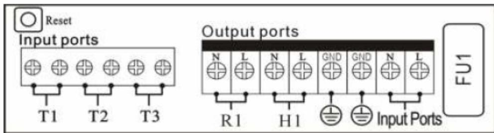
Кнопка “Reset”: эта кнопка находится на панели управления, если Система не работает, нажмите “Reset” для возврата к заводским установкам
