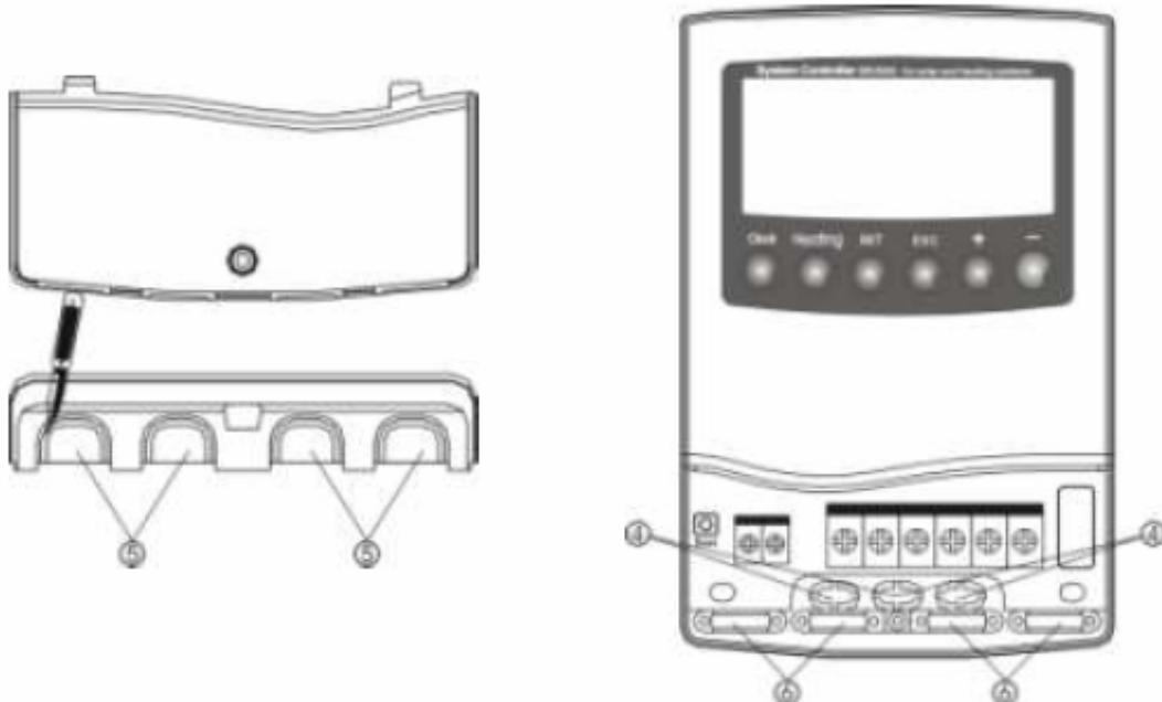
**Примечание:** гибкий провод должен быть закреплен в случае использования не жестких фиксаторов.
