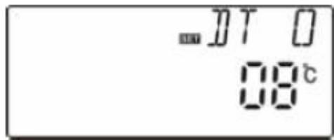
► Нажмите кнопки "+" "-", для выбора уровня температуры включения, диапазон выбора (OFF+2°C)~20°C , заводская установка – 8°C.
