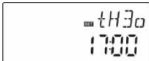
► Нажмите кнопку “+”, на экране появится "tH 3o 17:00", для установки времени включения и температуры третьего интервала времени функции нагрева.
