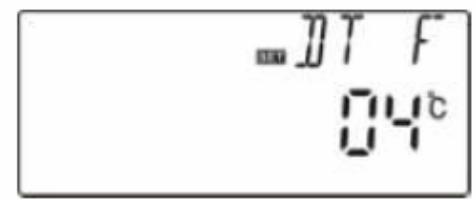
► Нажмите кнопки "+" "-", для выбора уровня температуры выключения, диапазон выбора 0°C~ (ON-2°C), заводская установка 4°C.
